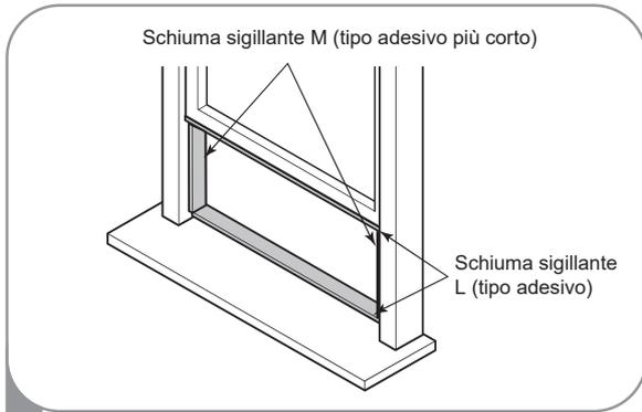
Tagliare la guarnizione in schiuma L (tipo adesivo) e M (tipo adesivo più corto) alla lunghezza adeguata e fissarla al battente e al telaio della finestra.
