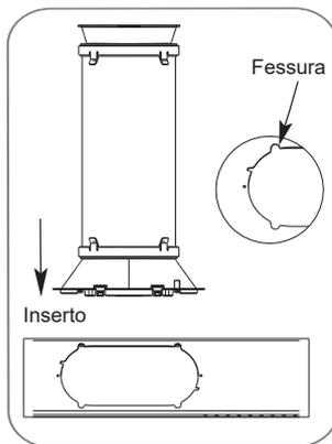
Allineare le linguette dell'adattatore di scarico della finestra con le fessure del pannello di sfiato. Inserire l'adattatore di scarico della finestra nell'apertura del pannello di sfiato.
