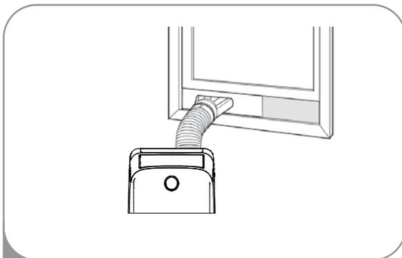
Inserire l'adattatore di scarico della finestra nell'apertura del pannello di sfiato.
