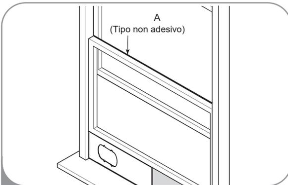
Tagliare la guarnizione in schiuma A (tipo non adesivo) alla larghezza della finestra. Infilare la guarnizione in schiuma A tra il vetro e la finestra per evitare che l'aria e i corpi estranei entrino nella stanza.
