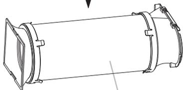
montaggio del tubo di scarico
