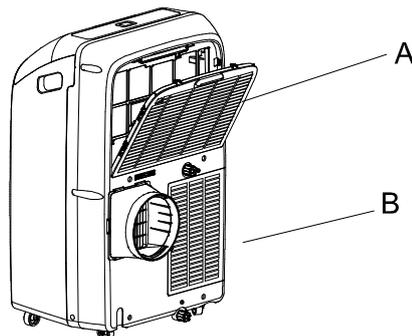
A. Sportello del pannello del filtro della presa d'aria di evaporazione
