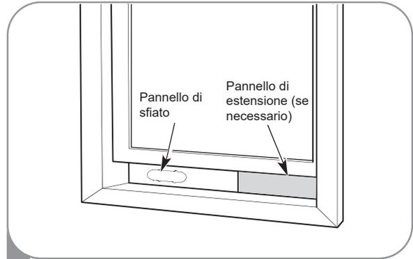
Inserire il gruppo del pannello di sfiato, compresi i pannelli di estensione, se necessario, nell'apertura della finestra. Estendere i pannelli di estensione alla larghezza della finestra.
