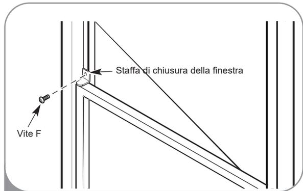
Installare la staffa di bloccaggio della finestra con una vite di tipo F come mostrato, se necessario.
